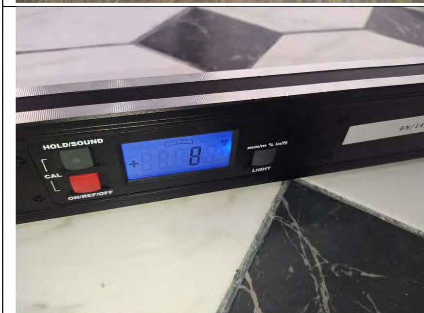
Фото №14. Измерение уровня напольного покрытия в кухне (керамическая плитка).
