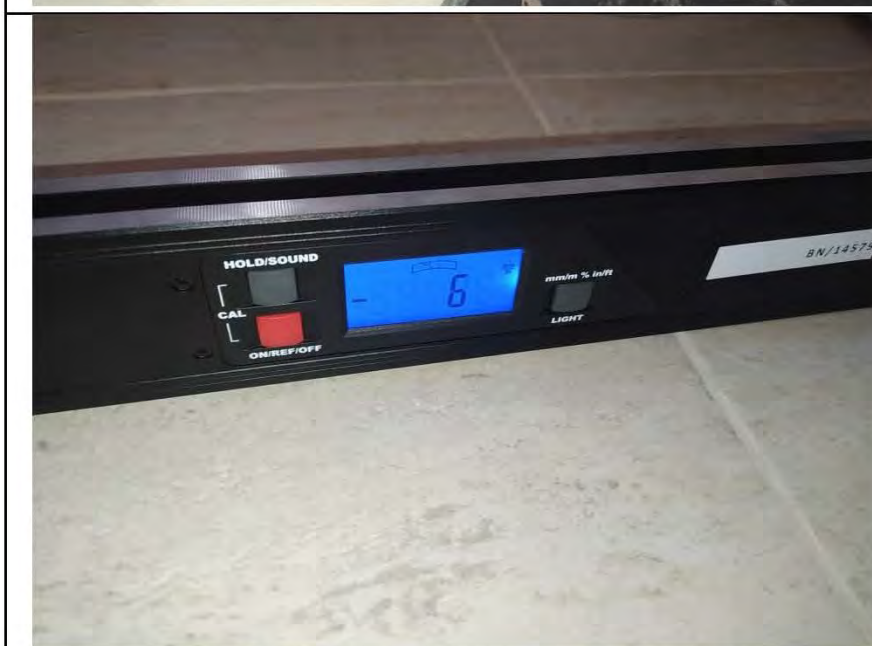
Фото №15. Измерение уровня напольного покрытия в ванной комнате (керамическая плитка).
