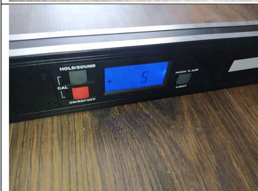
Фото №12. Измерение уровня напольного покрытия в прихожей
